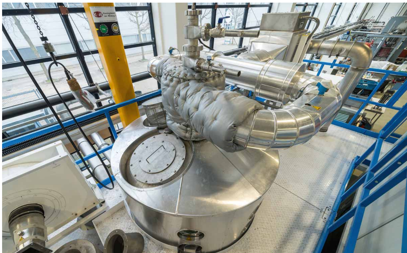
Bovenzijde van de sproeidroogkamer van de nieuwe sproeidroger in het Wageningse lab.
